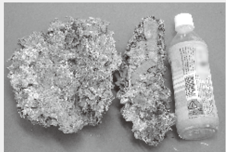
富士見環境センターの焼却炉内に付着したアルミニウム
